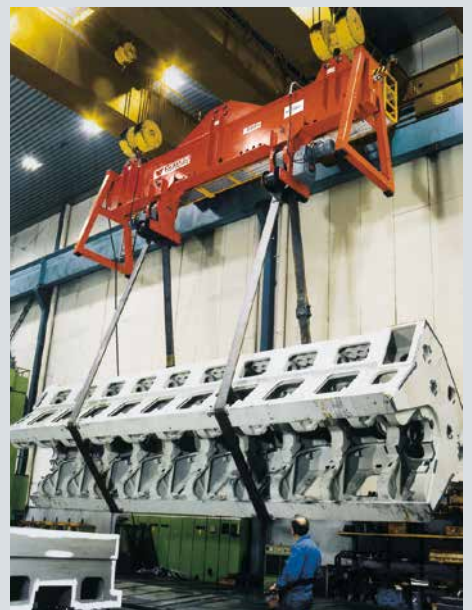
Tragfähigkeit / Capacity: 80 t Bandabstand / Belt distance: 1600 - 6000 mm Seitenverstellung / Adjustment: manuell / manual
