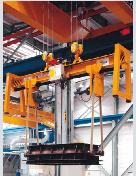
Tragfähigkeit / Capacity: 12 t Bandabstand / Belt distance: 1700 - 5000 mm Seitenverstellung / Adjustment: elektrisch / electrical
