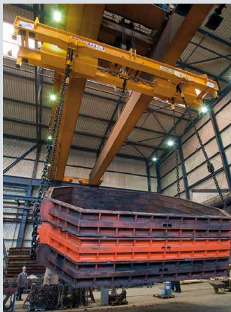
Tragfähigkeit / Capacity: 125 t Bandabstand / Belt distance: 3050 - 8800 mm Seitenverstellung / Adjustment: elektrisch / electrical
