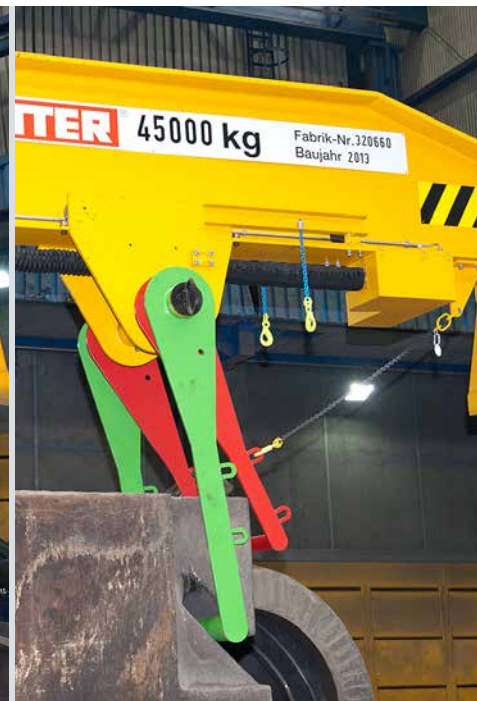
Abb. 2: Aufnahmemulde mit Bügel Fig. 2: Recess with bracket
