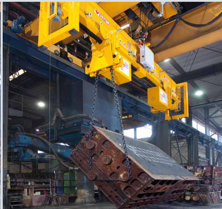
Die Drehbewegung kann in jeder beliebigen Position angehalten werden The turning process can be stopped in any position
