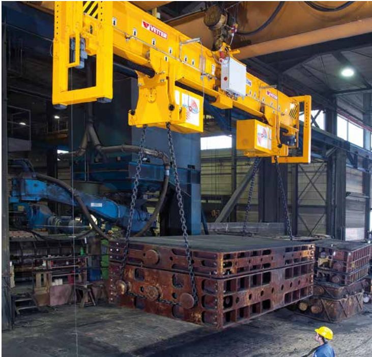
Formkasten in Ausgangsposition Initial position of moulding box
