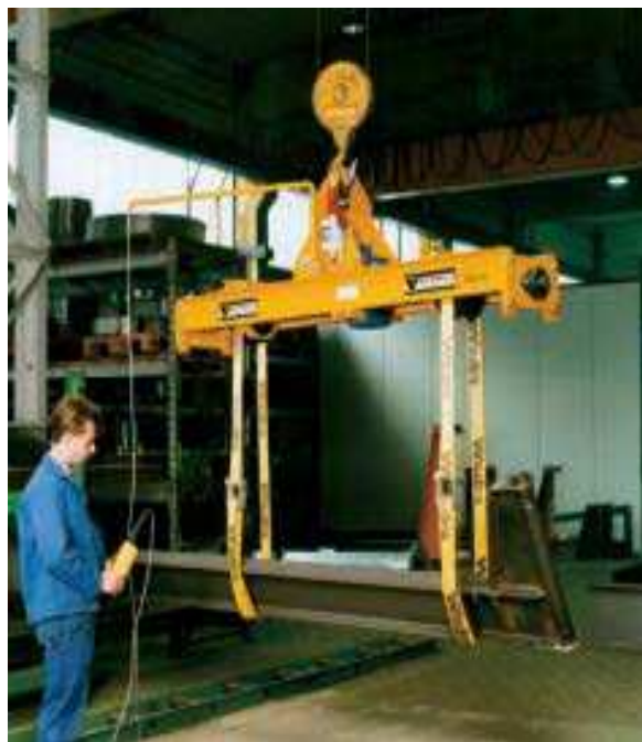
ROTOMAX 5000 с ручной боковой установкой
