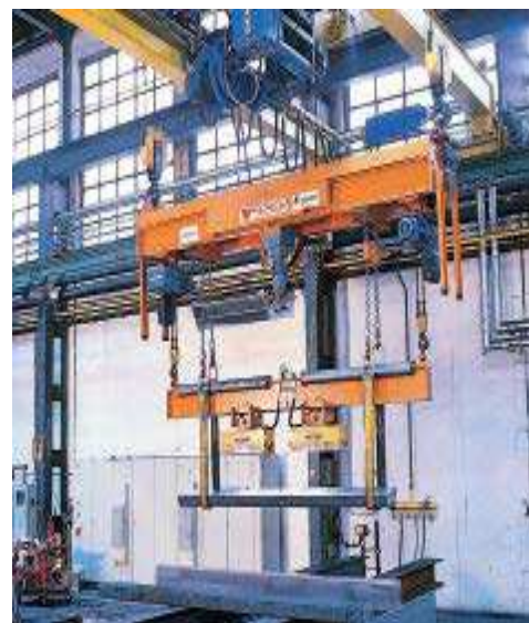
ROTO MAX VARIO 5т. с магнитной траверсой
