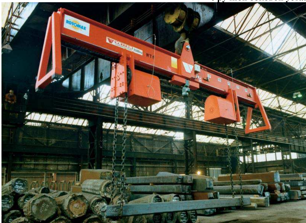
ROTOMAX 25000 с автоматизированной боковой установкой для переворачивания тяжелых кованных блоков
