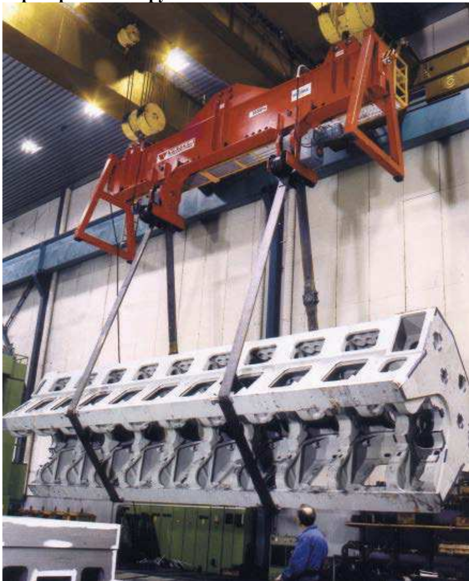
52т ROTOMAX переворачивает морской дизельный двигатель
