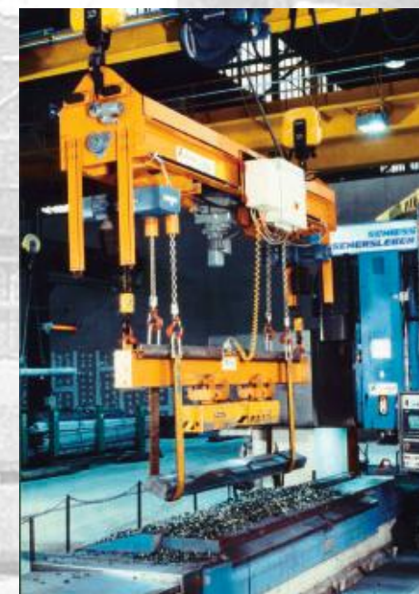
VARIO 5 t mit Magnettraversen im Edelstahlwerk VARIO 5 t with magnetic cross-head in a high grade steel company VARIO 5 t avec traverse magnétique dans une usine d'acier spécial
