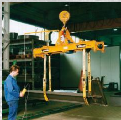
ROTOMAX® 5 000 mit Seitenverstellung von Hand ROTOMAX® 5 000 with manual side variation ROTOMAX® 5 000 à écartement réglable
