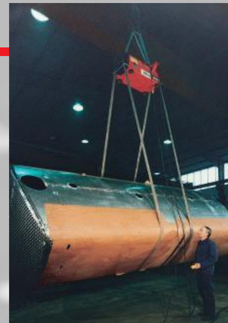
ROTOMAX® 5 000 im Tankesselbau ROTOMAX® 5 000 rotating boiler ROTOMAX® 5 000 pour la fabrication de citernes
