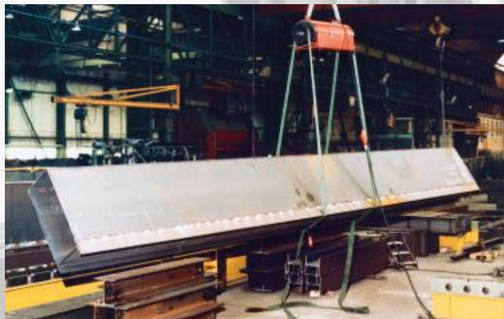
Wenden eines gehefteten Kastenträgers Turning of a box girder Retournement d'une pièce usinée lourde
