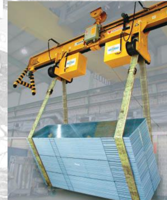
40 t ROTOMAX® beim Drehen eines Blechpaketes 40 t ROTOMAX® rotating a metal sheet package ROTOMAX® de 52 t tournant un paquet de tôles
