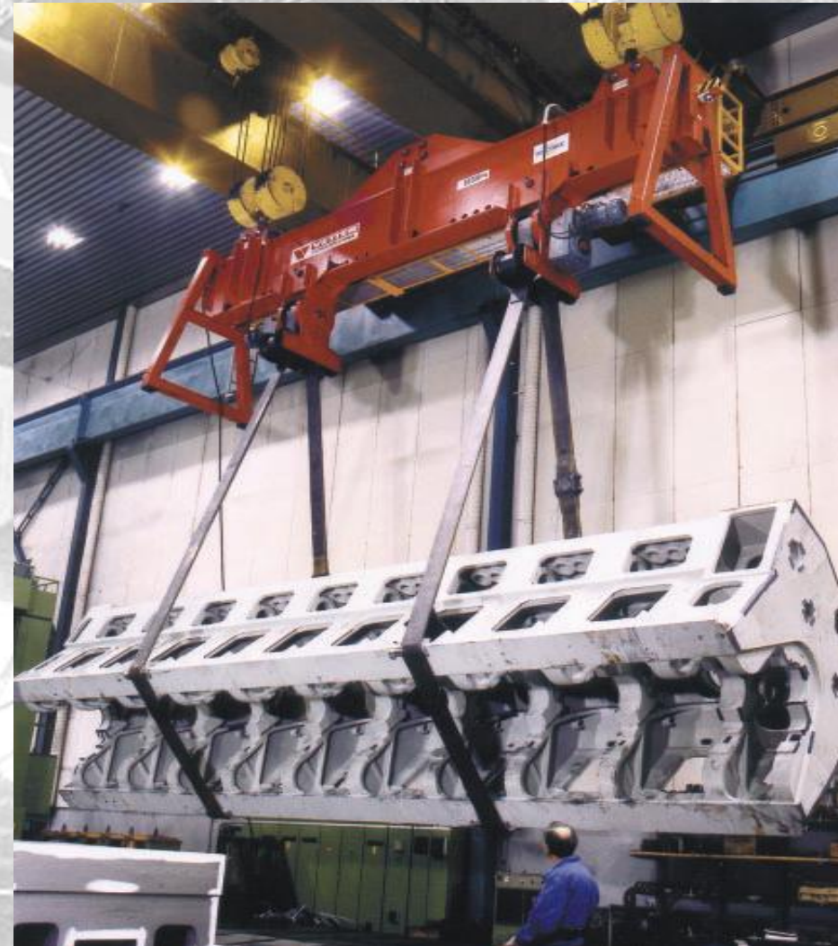
52 t ROTOMAX® beim Drehen eines Schiffsdieselmotors 52 t ROTOMAX® turning a marine diesel engine ROTOMAX® de 52 t tournant un moteur Diesel de marine
