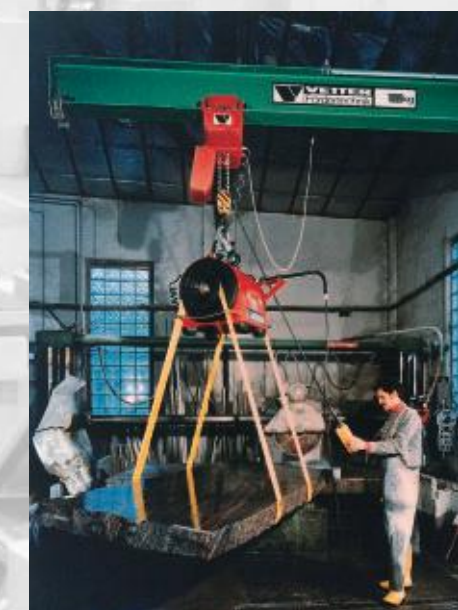
ROTOMAX® 5000 im Waggonbau ROTOMAX® 5000 turning a carriage bogie ROTOMAX® 5000 tournant un élément d'un wagon
