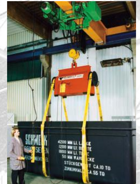
ROTOMAX® 10 000 beim Drehen eines Verzinkungskessels ROTOMAX® 10 000 turning of a galvanizing bath ROTOMAX® 10 000 lors du retournement d'une cuve de galvanisation
