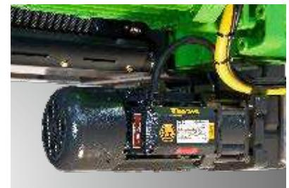
Непрямой подвод кабеля, очень высокий уровень безопасности, реализуется классом защиты: повышенная безопасность «е» и взрывонепроницаемая инкапсуляция «d». Соединение отсеков «Ex e» к «Ex d» осуществляется благодаря многожильному проходному изолятору.
