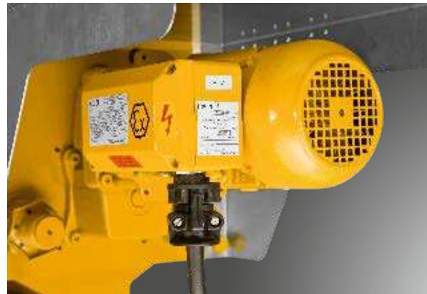
Приводы движения во взрывозащищенном исполнении для Зоны 1 и Зоны 21 предназначены для повторно-кратковременного режима работы. Они имеют двигатель, тормозящий с помощью подвижного ротора, с конусным тормозом и противовесом для комфортного отношения ускорения и торможения. Все двигатели с переключаемыми полюсами предназначены для стандартных двух скоростей перемещения. Особенно бесшумный редуктор не требует особого ухода, благодаря долговечной масленой смазке.
