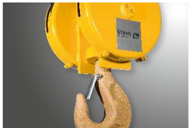
Для использования при высокой и очень высокой скорости передвижения грузовые крюки, как и массивные части, потенциально ударных поверхностей, покрываются бронзой. Сверх этого, все другие внешние поверхности крюковой блочной обоймы могут быть также покрыты бронзой в качестве защиты от искр.
