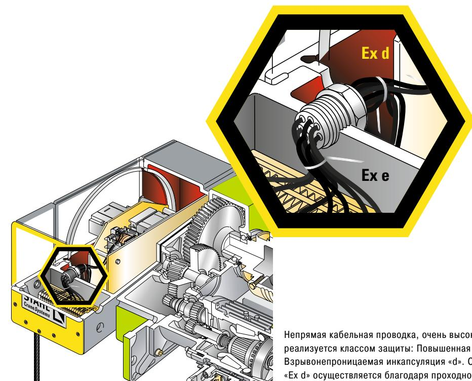
Непрямая кабельная проводка, очень высокий уровень безопасности, реализуется классом защиты: Повышенная безопасность «е» и Взрывонепроницаемая инкапсуляция «д». Соединение отсеков «Ex e» к «Ex d» осуществляется благодаря проходному изолятору.
