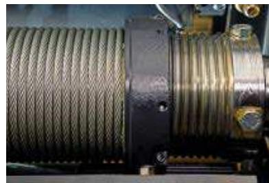
Износостойкое кольцо канатной направляющей из стального литья GJS (уст. обозначение GGG) обладает очень большой прочностью и не имеет температурных ограничений, это же относится и к цепной направляющей, используемый класс защиты: конструкционная безопасность «с».
