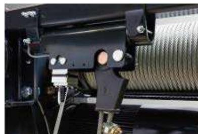
Отключение при перегрузке осуществляется с помощью двухканальных датчиков нагрузки, которые посылают аналоговые сигналы. В зависимости от запасовки используются различные датчики (LCD, LSD).
