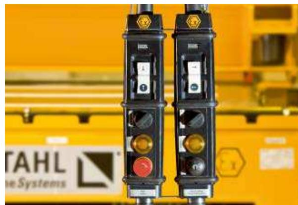
Устройства управления SWH 5 ex предназначены специально для управления подъемными механизмами и кранами во взрывоопасных зонах. Приведение в действие, как правило, 2-ступенчатое, что и делает возможным быстрое переключение от режима «быстро» на режим «медленно» и наоборот. Все устройства управления имеют кнопку «Аварийная остановка», которая выполнена в соответствии с предписанием IEC/EN 60947-5-5.
