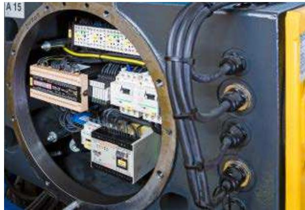
Герметичная инкапсуляция для Зоны 1 и Зоны 2: корпус из стального листа или алюминиевый используется как одинарный корпус, а также в комбинации. Все нужные компоненты такие как трансформатор, контакторы, предохранители, измерительные инструменты и выключатели могут встраиваться в корпус, сконструированный по модульному принципу. С помощью многожильного проводного изолатора устанавливается соединение с клеммной коробкой (повышенная безопасность Ex e).
