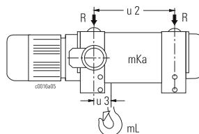
**2****Bestimmung der Antriebsradlast****Determination of drive wheel load****Détermination de la réaction au galet entraîné**
