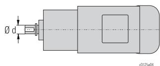
**Fahrantrieb mit glatter Welle**   **Travel drive with plain shaft**   **Groupe d'entraînement avec arbre simple**
